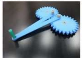
Fig. 5 リンク機構と歯車の直線運動機構
