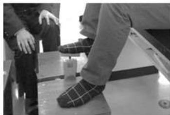
Fig. 2 デジタルフォースゲージによる踏み力の計測
